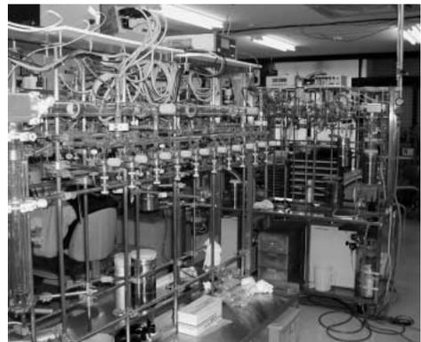
写真5 AMS年代測定用試料処理装置
